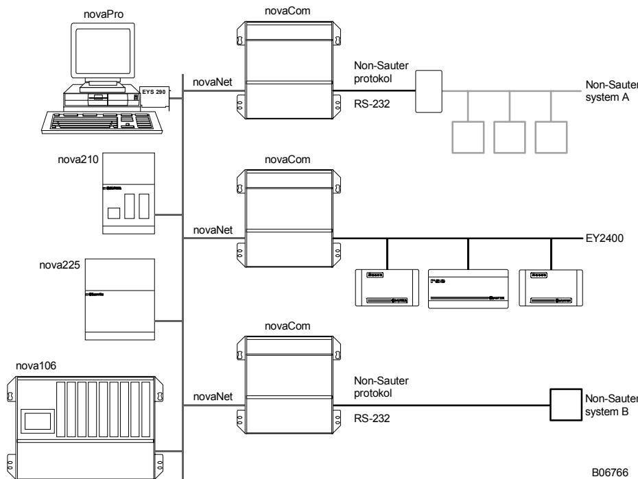
В случае использования более 4032 адресов команд перехода (большой, полностью используемый каркас), подключаются два или большее количество **novaComs**. Но интерфейс связи (EY1 280 F001) является главным для нескольких шин. По этой причине, сшинами несаутеровского производства может использоваться только один **novaCom**.
