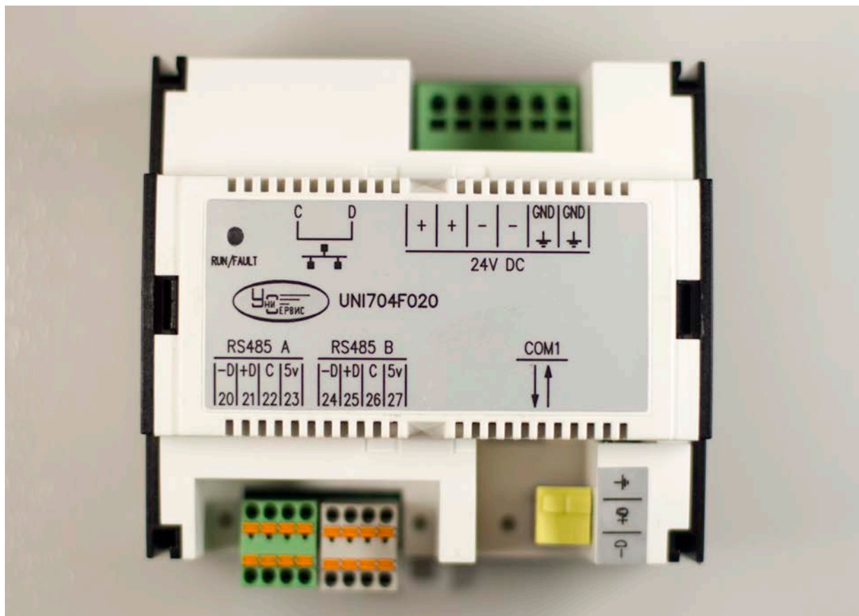
Рис. 2.1. Внешний вид контроллера, исполнение UNI704F020.
