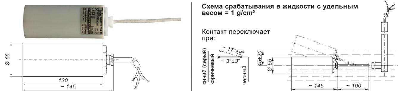
Схема срабатывания в жидкости с удельным весом = 1 g/cm<sup>3</sup>
