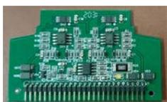
**Тип 4 – UNI740AO-U** 4 выхода напряжения 0-10V
